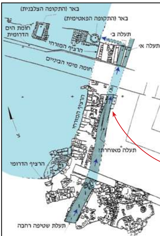
איור 21. תוכנית השטח בדרום-מזרח הנמל הפנימי, מדרום לחומת ימי הביניים (הצלבנית). שימו לב לרציפי הנמל הפנימי, המזרחי והדרומי, ולתוואי תעלת השטיפה (רבן תשס"ד, 5; שרטוט: ז' פרידמן)
